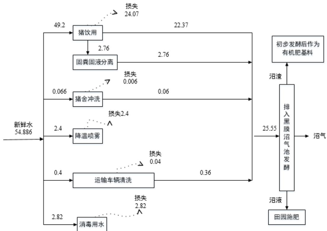
图 3.2-1 项目夏季水平衡图 ( $\text{m}^3/\text{d}$ )
