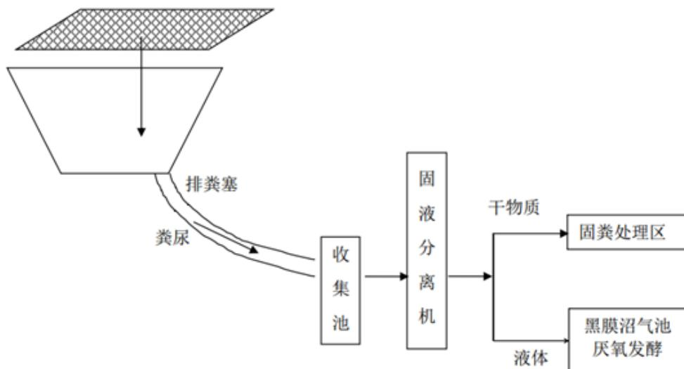
图 3.1-5 干清粪工艺流程图
