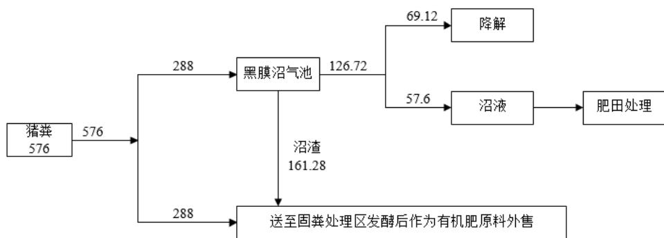
图 3.3-5 项目猪粪、沼渣平衡图（单位：干 t/a）
