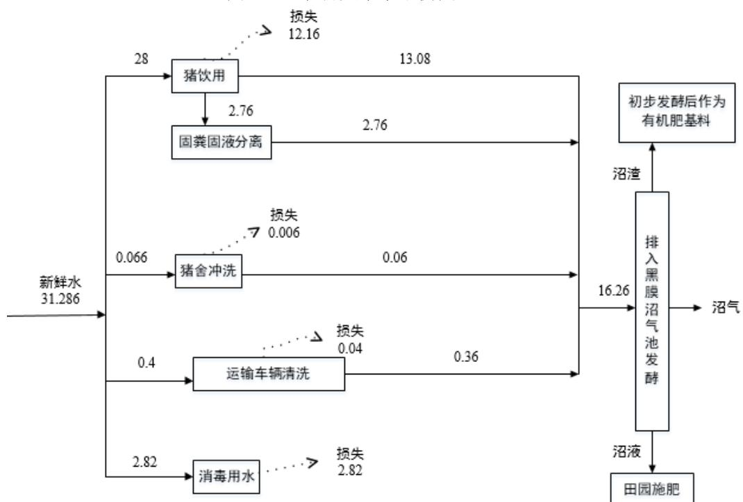
图 3.2-2 项目其他季节水平衡图 ( $m^3/d$ )
