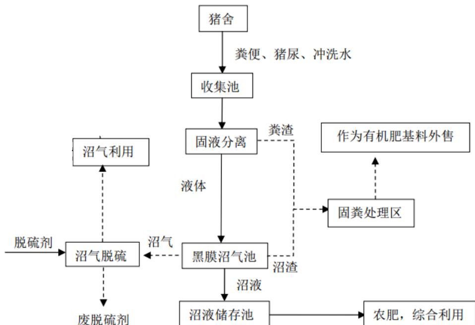
图 3.1-6 项目污水处理工艺流程图
