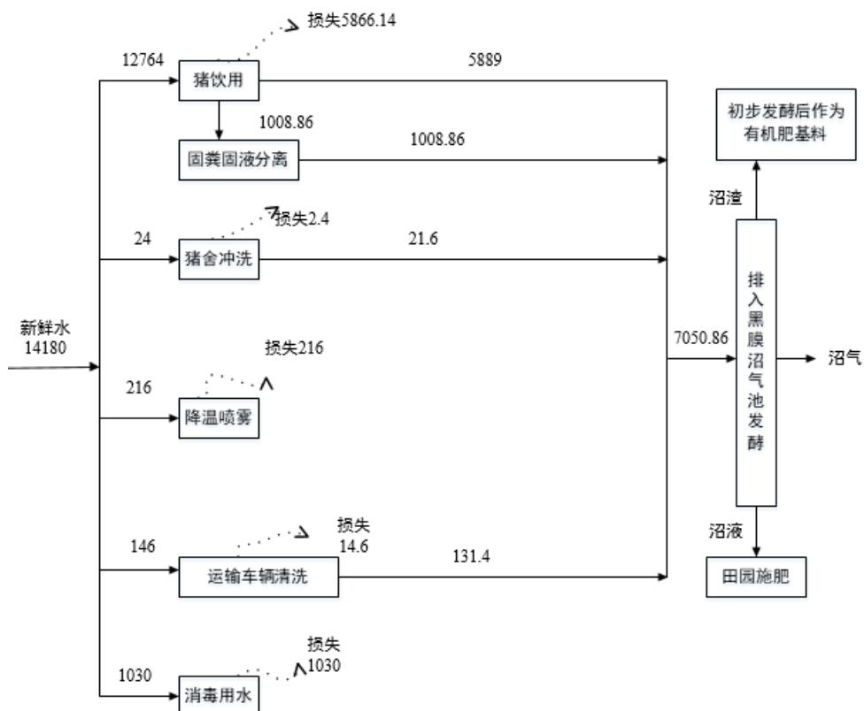
图 3.2-3 项目年水平衡图 ( $m^3/a$ )
