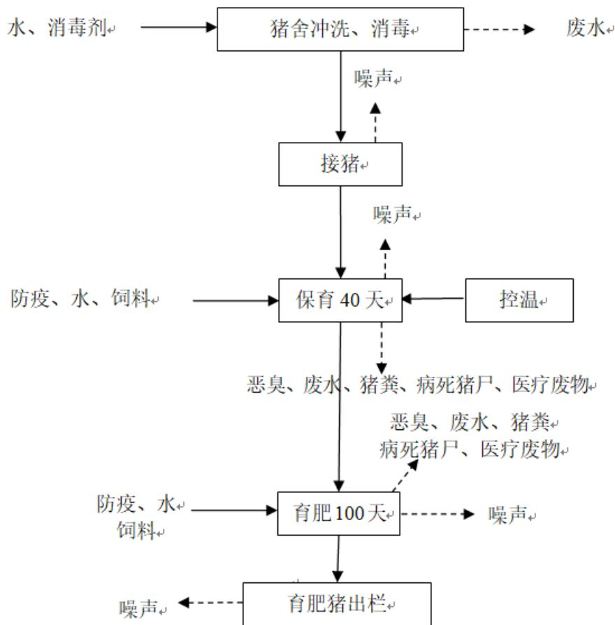
图3.1-3本项目育肥猪养殖过程工艺流程及产污环节图
