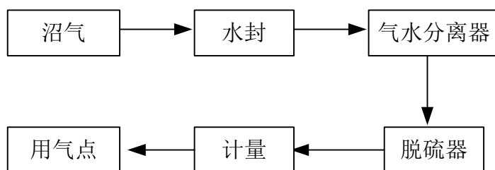
图 3.1-2 沼气净化示意图
