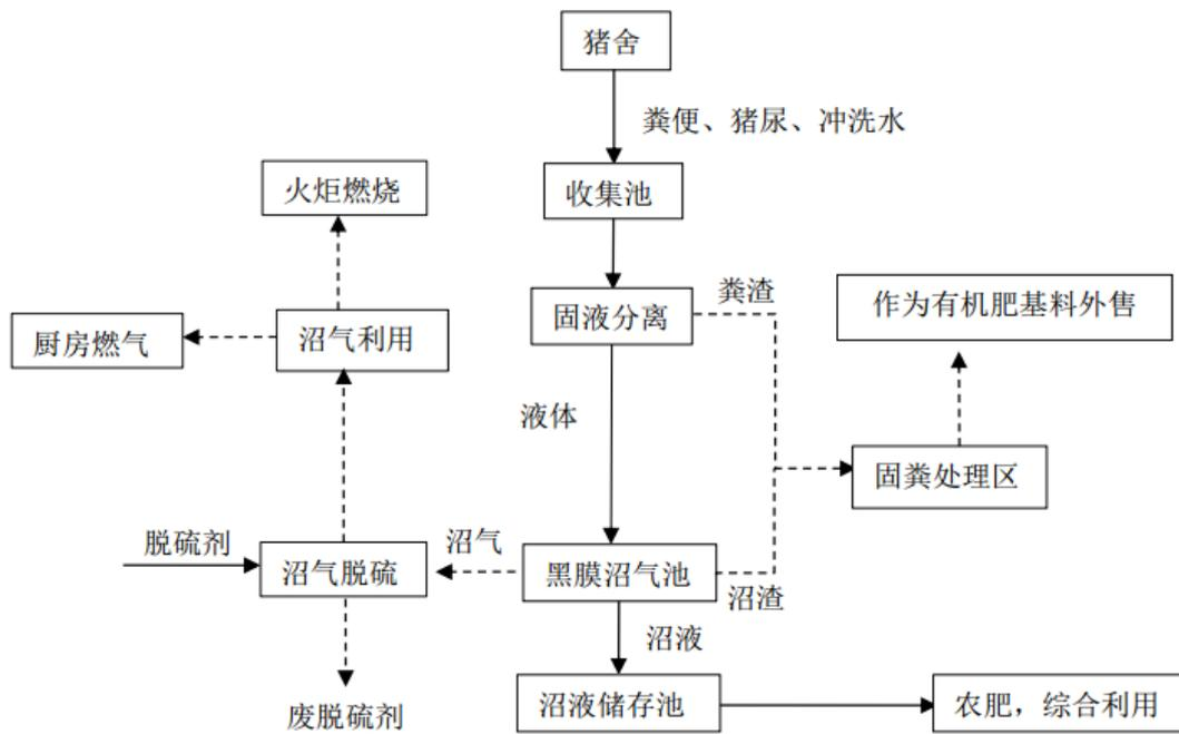
图 3.1-6 项目污水处理工艺流程图
