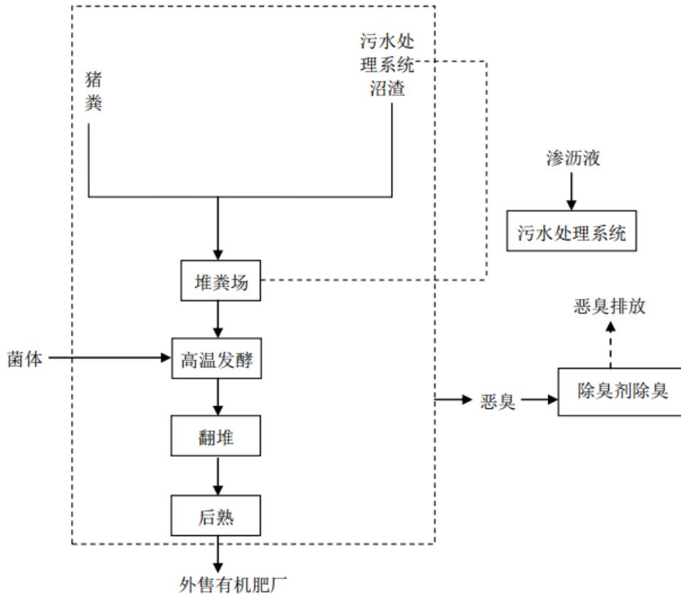
图3.1-12堆肥处理工艺流程及产污环节
