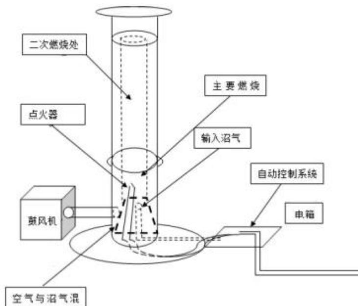
图 7.2-1 沼气利用工艺流程图
