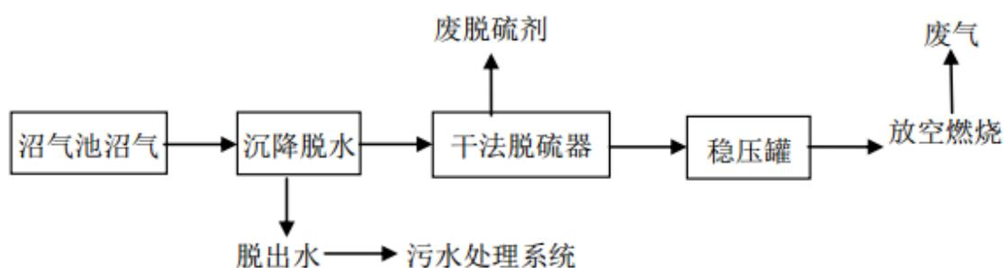
图3.1-11 沼气利用流程及产污环节
