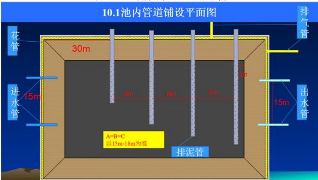
图 3.1-7 黑膜沼气池内管道铺设示意图
