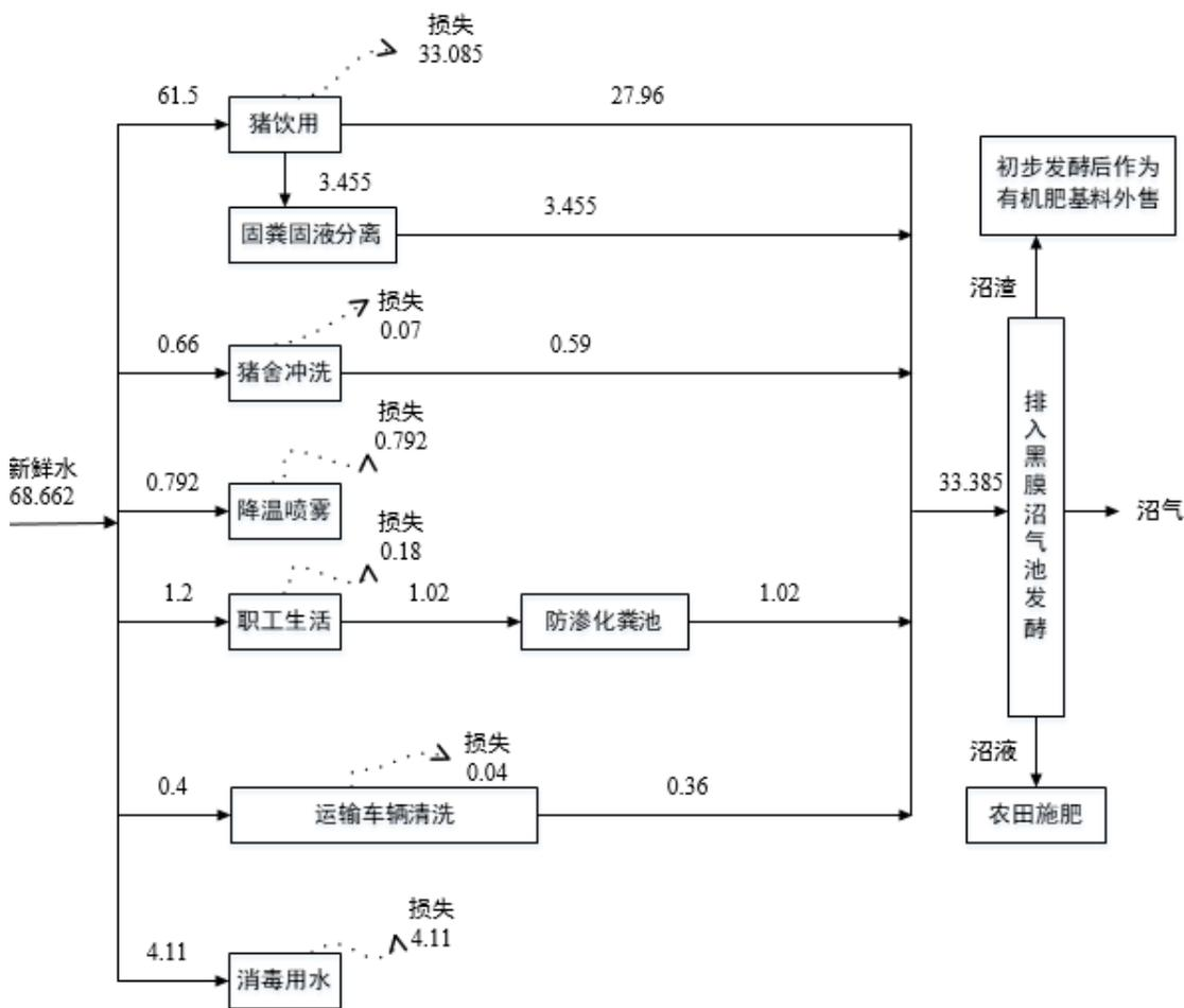
图 3.2-1 项目夏季水平衡图 (m³/d)
