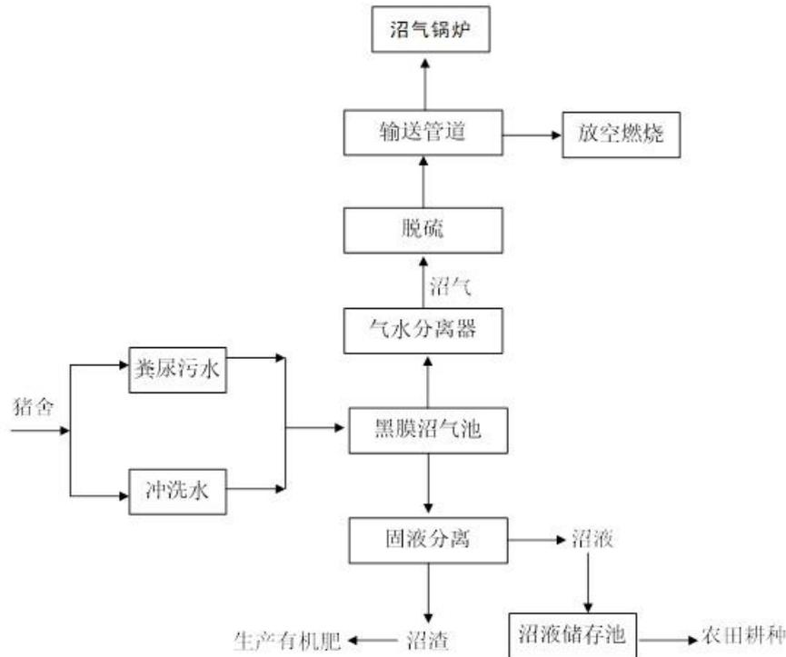
图 3.1-1 沼气利用工艺流程图
