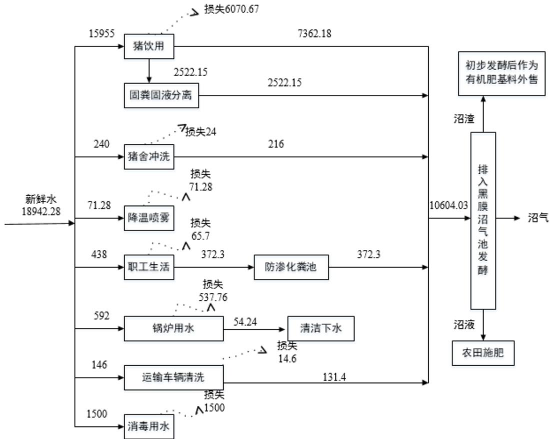
图 3.2-3 项目年水平衡图 (m<sup>3</sup>/a)
