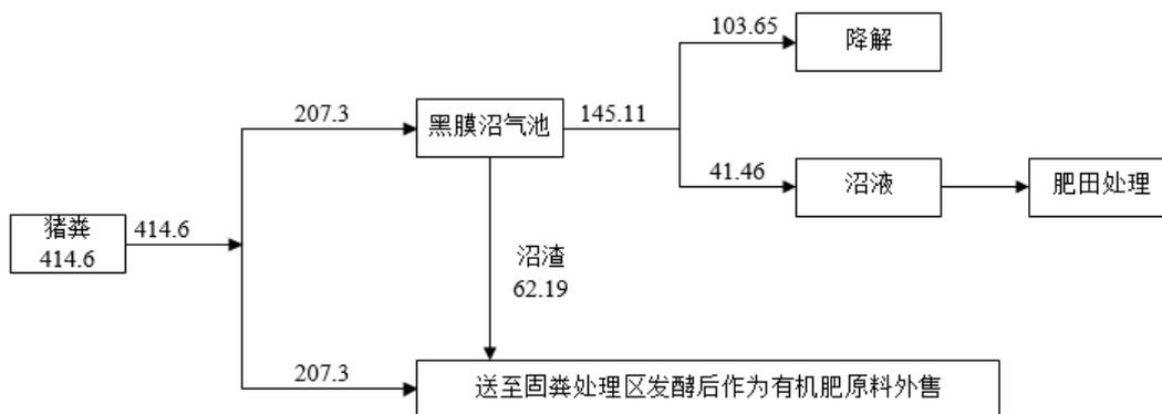
图 3.3-6 项目猪粪、沼渣平衡图 (单位: 干 t/a)
