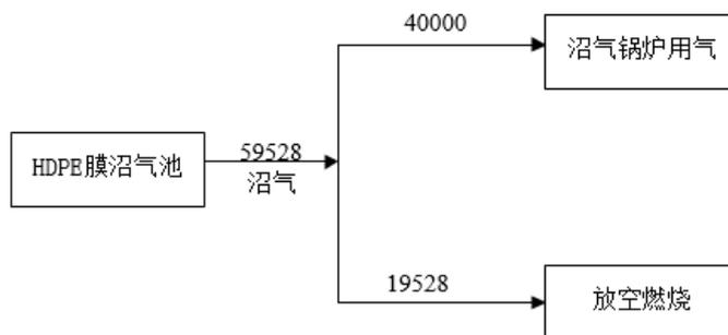
图 3.3-5 项目沼气平衡图（单位 m<sup>3</sup>/a）
