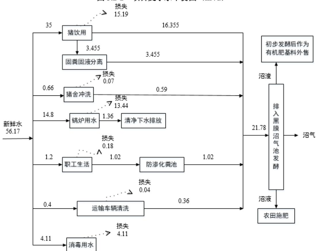
图 3.2-2 项目其他季节水平衡图 (m<sup>3</sup>/d)
