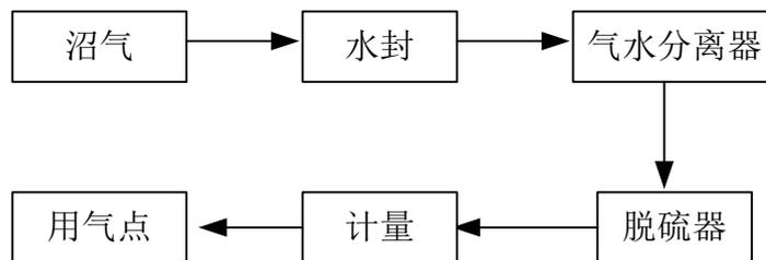
图 7.2-2 沼气净化示意图
