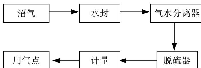
图 3.1-2 沼气净化示意图
